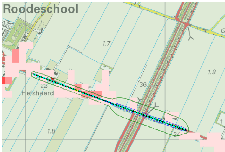
Figuur 4: Overzicht invoer RBMII en inzicht in plaatsgebonden risico 10^{-8} in het groen
