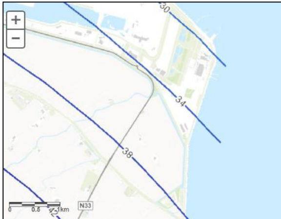
Afbeelding 7.8 Verwachte bodemdaling t/m 2080 in cm
