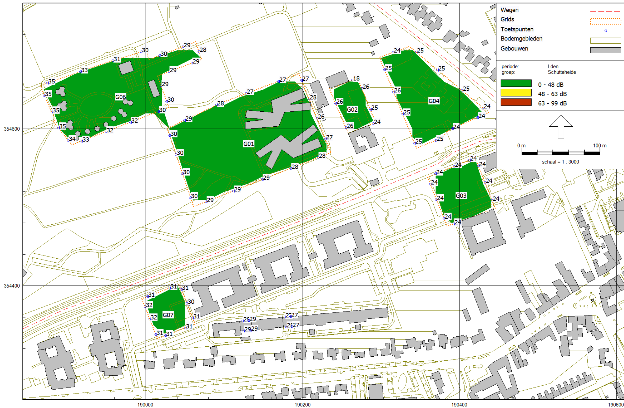
Figuur B2.7: Rekenresultaten exc. aftrek artikel 110g Wgh (4,5 meter)
