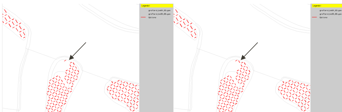
Afbeelding 21. Natte en droge cellen bij (droog is rood streepje) ter plaatse van cirkel in Afbeelding 20 MAASBR_REF (links) en MAASBR_DO2 (rechts) bij een afvoer van 1.500 \text{ m}^3/\text{s} .
