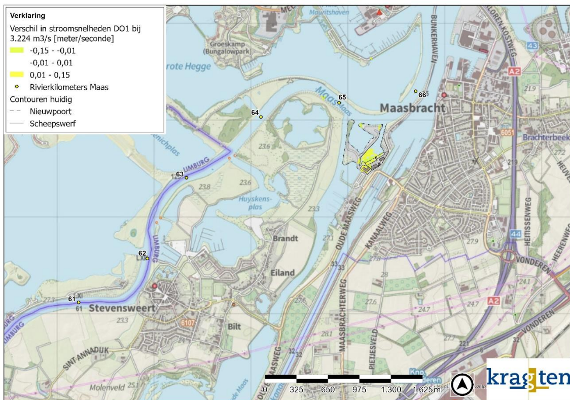
Afbeelding 19. Stroomsnelheidsverschillen als gevolg van MAASBR_DO1 bij een afvoer van 3.224 m³/s bij Sint Pieter.
