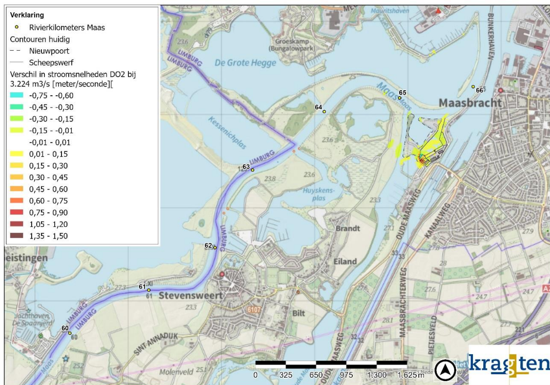
Afbeelding 25. Stroomsnelheidsverschillen als gevolg van MAASBR_DO1 bij een afvoer van 3.224 m³/s bij Sint Pieter.
