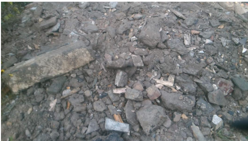
Foto 19. Asbestverdacht (plaat)-materiaal in sleuf 8
