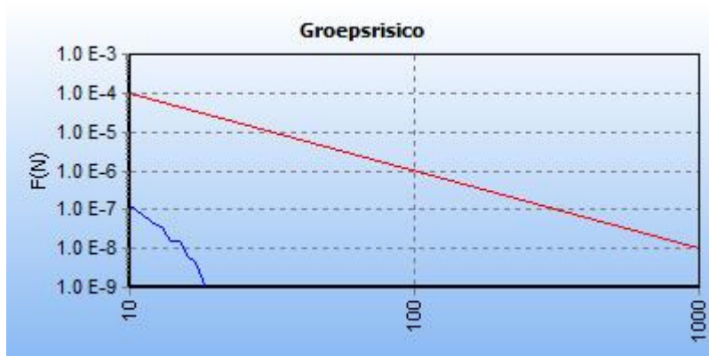
Figuur 2.8: fN-curve buisleiding A-513-01-deel-1, na planrealisatie
