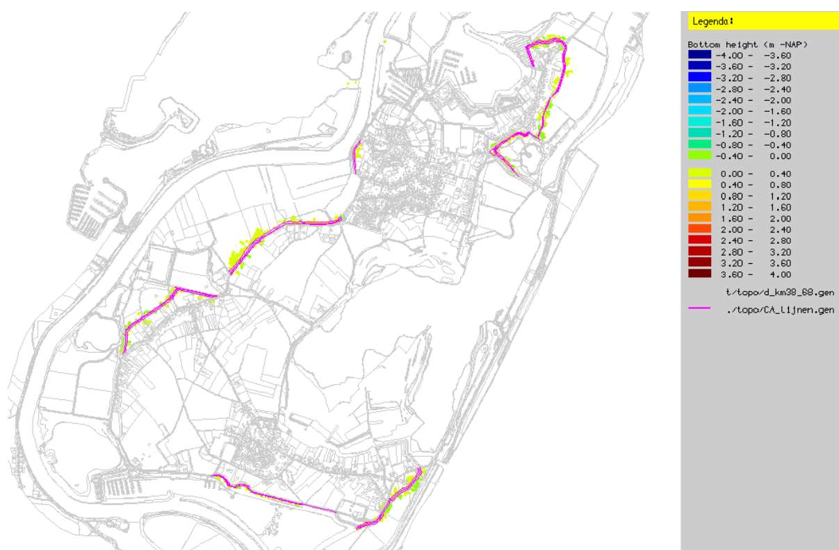
Figuur 13 Dijkverbetering Cluster A, bodemhoogte verschil (m), ontwerp Cluster A versus referentie
