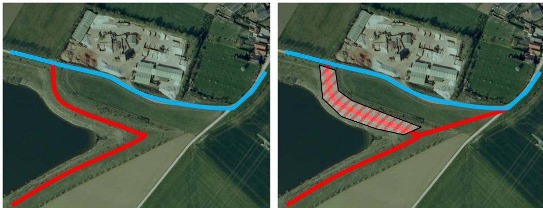
Afbeelding 13: Links: Ligging van dijkkring 81 (blauwe lijn) en de dijk in het voorland (rode lijn). Rechts: Door de twee dijken te verbinden zijn ze verbonden via een korte dijk. Het dijkdeel dat is gearceerd kan vervallen en de grond kan worden gebruikt.
