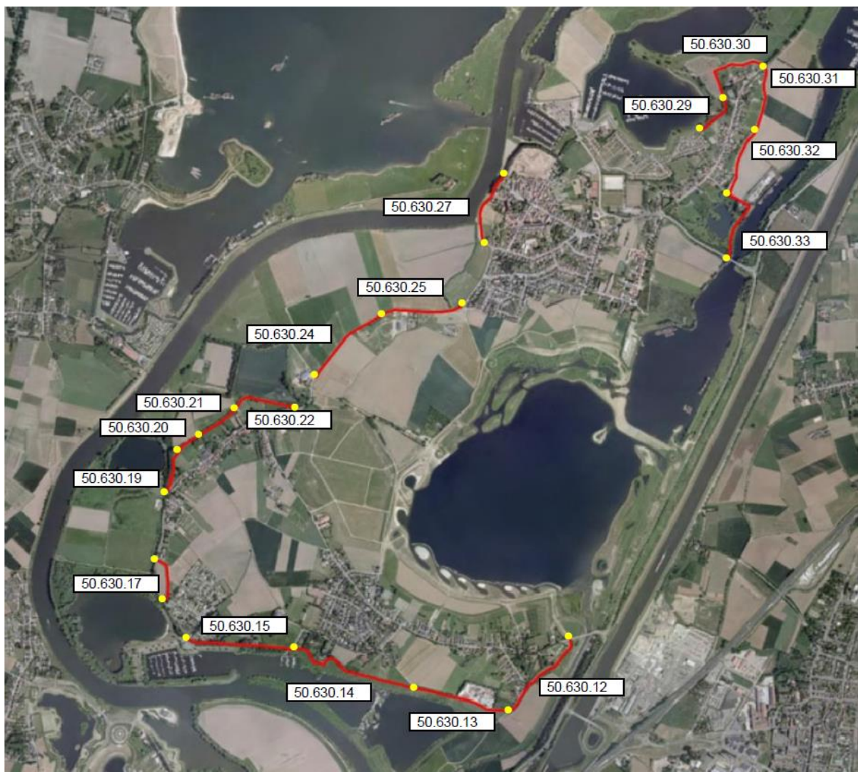
Figuur 3 Ligging van sluitstukkaden van dijkkring 81 (Movares e.a., 2015a)
