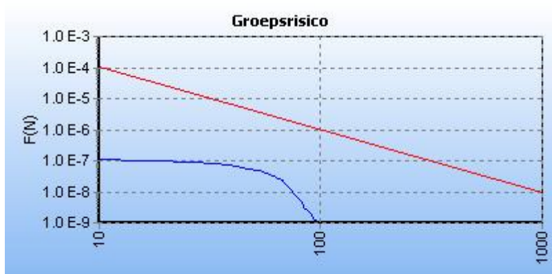
Figuur 5.4 FN curve voor A-521 van N.V. Nederlandse Gasunie voor de kilometer tussen stationing 69550.00 en stationing 70550.00 na realisatie plan.
