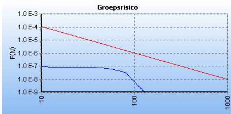
Figuur 5.1 FN curve voor A-585 van N.V. Nederlandse Gasunie voor de kilometer tussen stationing 66150.00 en stationing 67150.00 voor realisatie plan.
