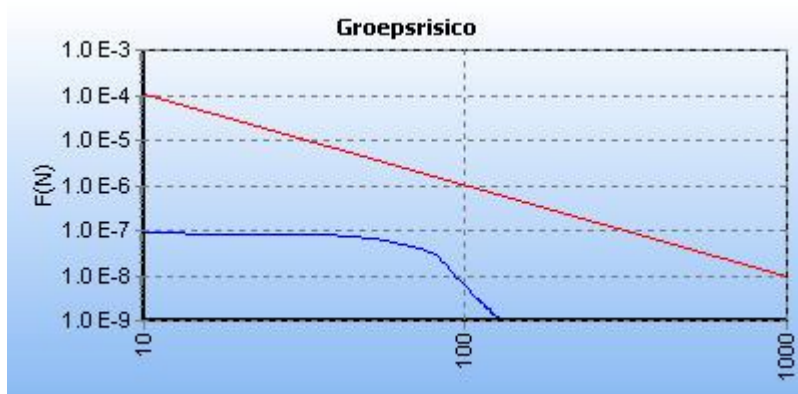
Figuur 5.2 FN curve for A-585 van N.V. Nederlandse Gasunie voor de kilometer tussen stationing 66150.00 en stationing 67150.00 na realisatie plan.
