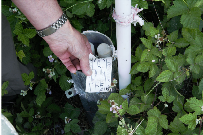
Figuur 8. Op het terrein staan enkele in 2016 geplaatste grondwatermeetpunten.
