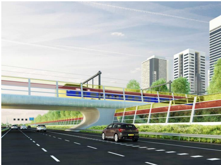
Zonnepanelen geïntegreerd in geluidswal langs wegen. Ook denkbaar bij de N 280 of op en langs taluds van kanalen en (spoor-) wegen.
