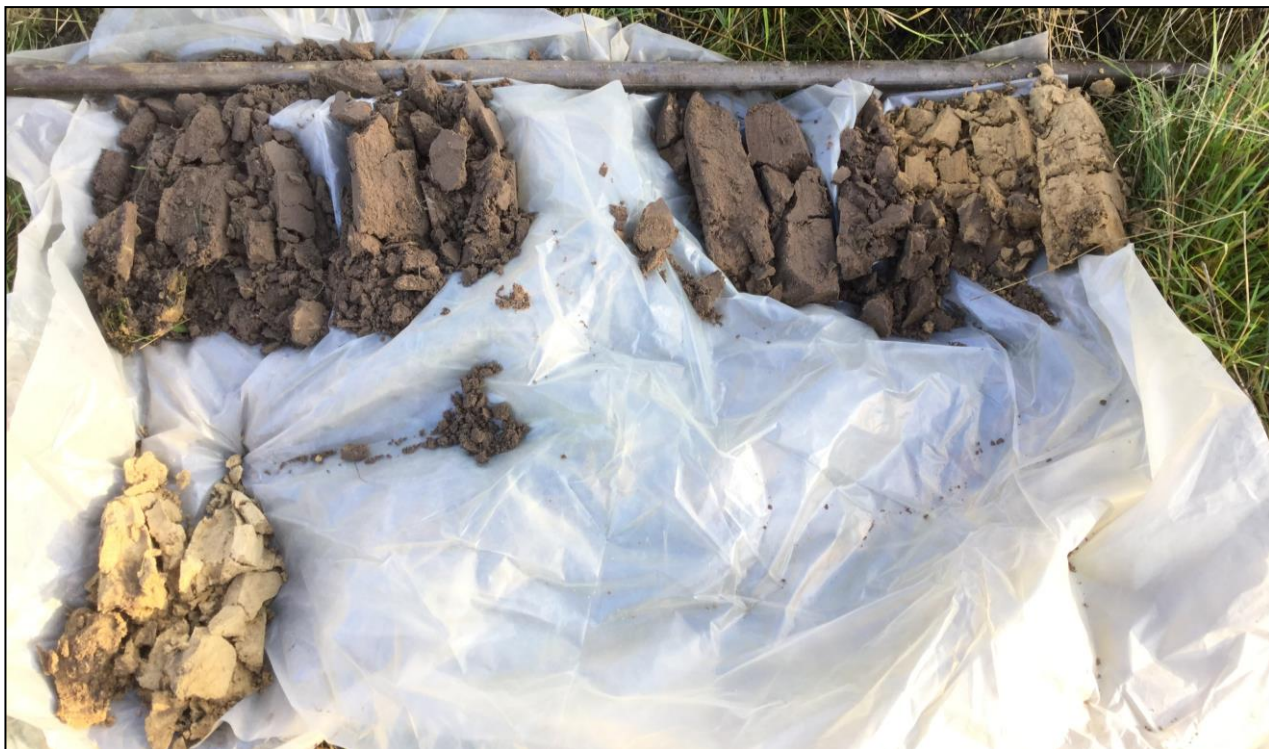
Figuur 10: Het boorprofiel van boring 4. De leesrichting is van linksboven naar rechtsonder (0-120 cm -mv).
