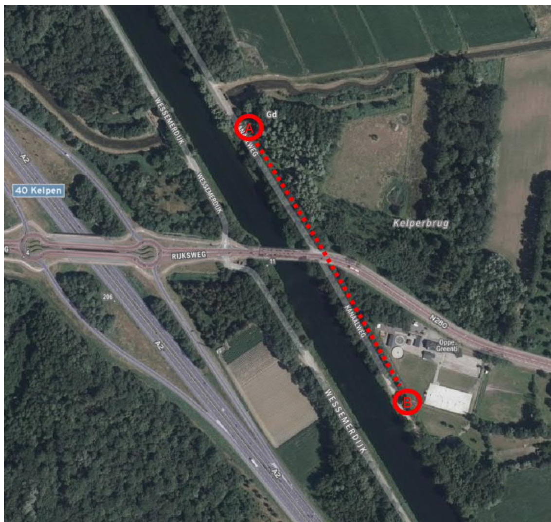
Afbeelding 1. Globale aanduiding van het plangebied, waarin de rode cirkels de beide werklocaties (A en B) markeren en met een stippellijn de ondergrondse boring is aangegeven. Bron luchtfoto: PDOK-viewer.
