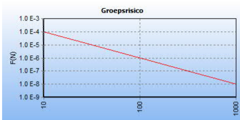
5.4 Figuur 5.4 FN curve voor 5867_leiding-Z-540-01-deel-1_incl verl van N.V. Nederlandse Gasunie voor de kilometer tussen stationing 920.00 en stationing 1920.00
