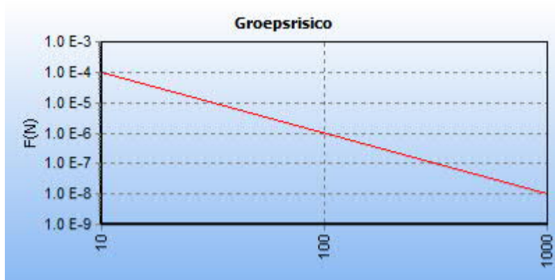
5.4 Figuur 5.4 FN curve voor 6268_leiding-Z-540-01-deel-1_incl verl van N.V. Nederlandse Gasunie voor de kilometer tussen stationing 420.00 en stationing 1420.00
