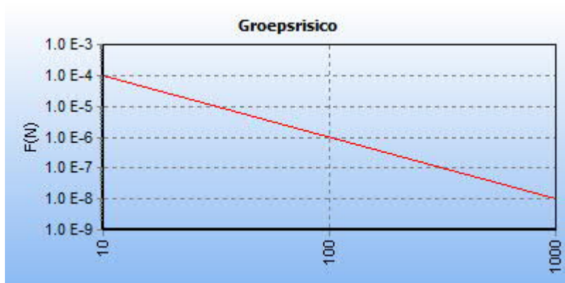
5.4 Figuur 5.4 FN curve voor 5867_leiding-Z-540-01-deel-1_incl verl van N.V. Nederlandse Gasunie voor de kilometer tussen stationing 920.00 en stationing 1920.00
