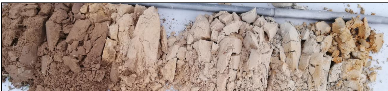
Figuur 6: Het boorprofiel van boring 4. De leesrichting is van links naar rechts (0-100 cm -mv). Dit is het meest voorkomende profiel binnen het plangebied (met in acht name van dikte verschillen in de afzonderlijke boringen).
