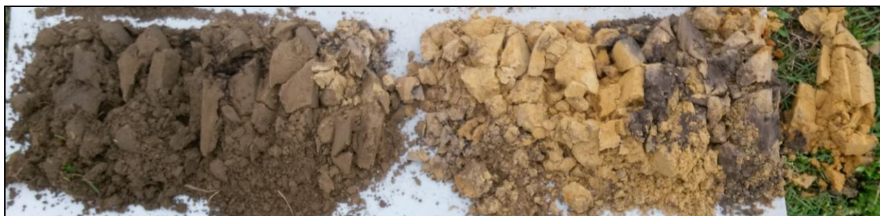
Figuur 8: Het boorprofiel van boring 10. De leesrichting is van links naar rechts (0-120 cm –mv). Duidelijk zichtbaar is de humeuze laag tussen 80 en 100 centimeter -mv.
