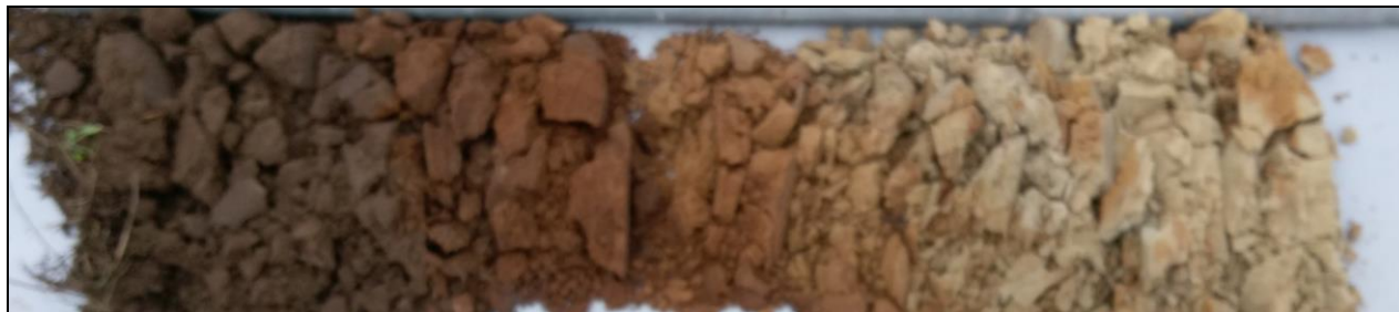
Figuur 7: Het boorprofiel van boring 5. De leesrichting is van links naar rechts (0-110 cm –mv). Ondanks de onscherpe foto is nog een duidelijke B- en BC-overgang waar te nemen.
