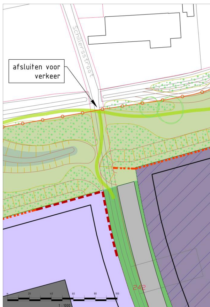
Figuur 7: Afscherming doodlopende weg bedrijventerrein middels grondwal en groenvoorzieningen.
