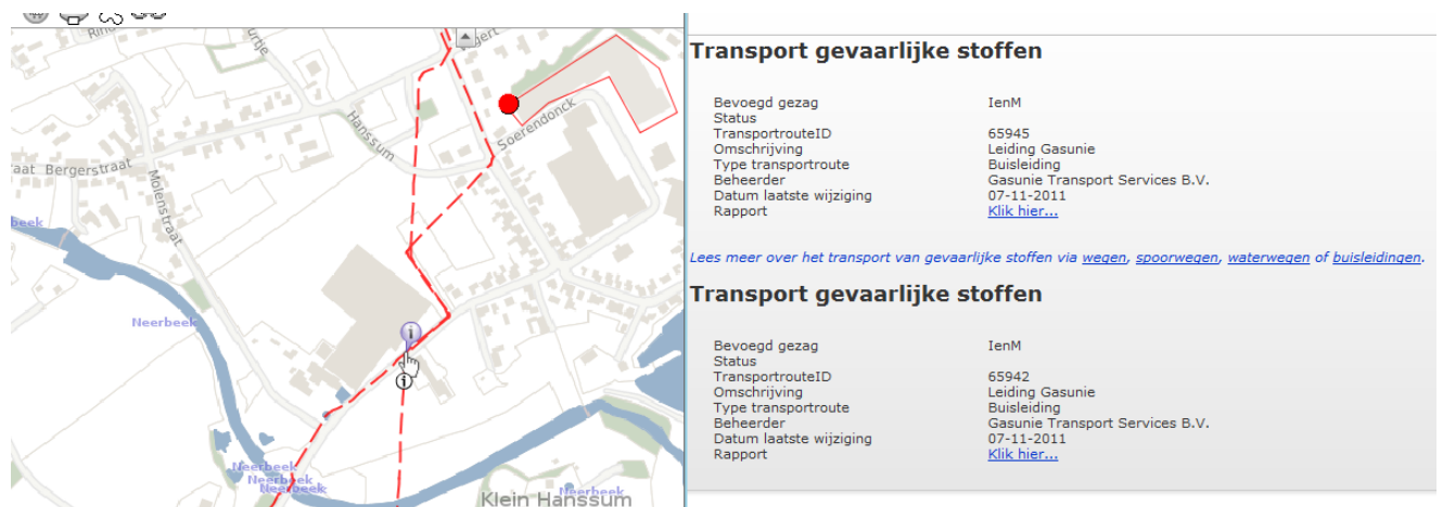
Figuur 11: Gasleiding van Gasunie binnen 15 meter van de bedrijfslocatie.
