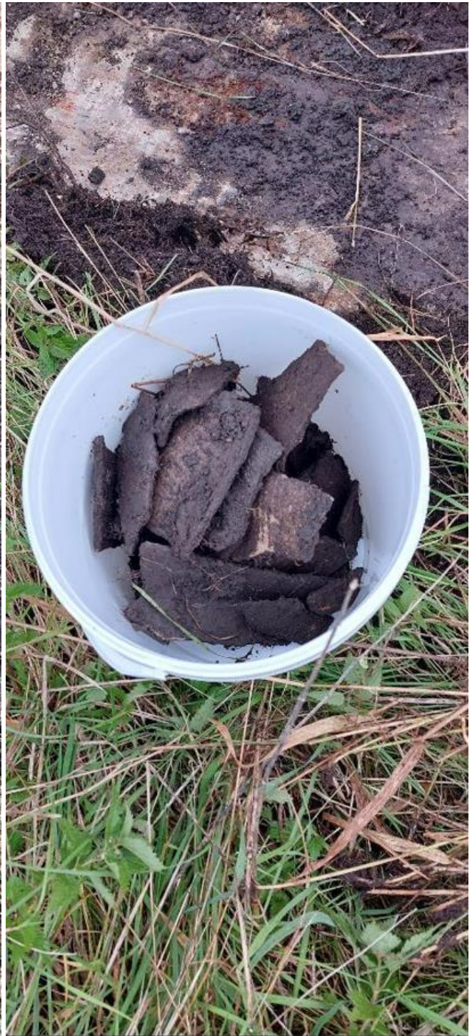
Foto 2: Asbesthoudend materiaal uit Sleuf A05 (toplaag tot 0,2 m-mv)
