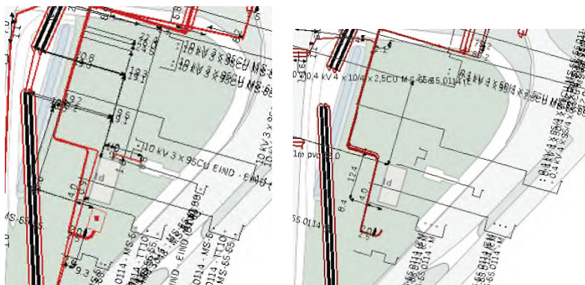
Figuur 9 en 10: kabels middenspanning en laagspanning
