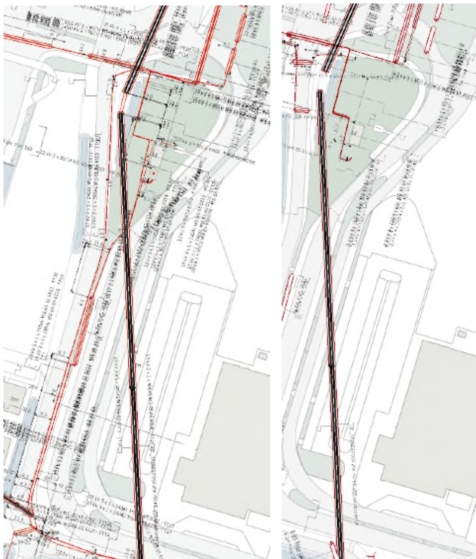
Figuur 11 en 12: kabels middenspanning en laagspanning
