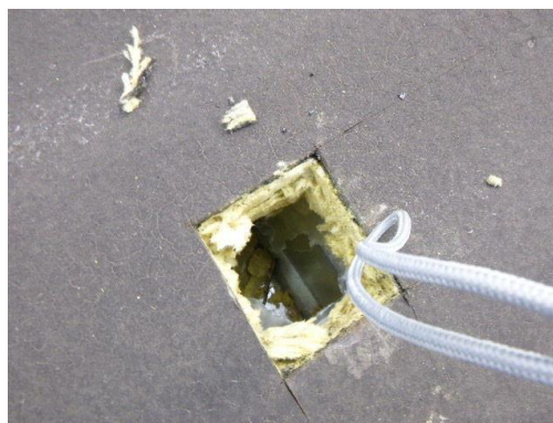
Foto 16: zie foto 15, de bitumen dakbedekking bemonsterd als M5 en M6 en als asbestvrij beoordeeld.
