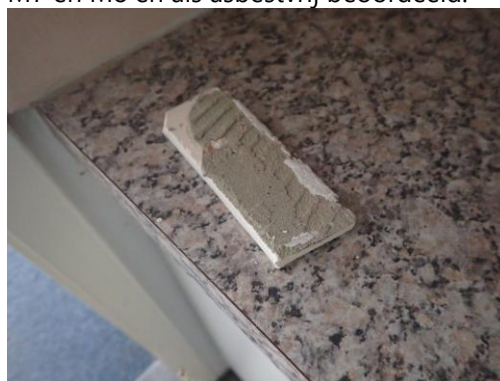
Foto 4: zie foto 3, de tegellijm van de wandtegels bemonsterd als M9 en M10 en als asbestvrij beoordeeld.
