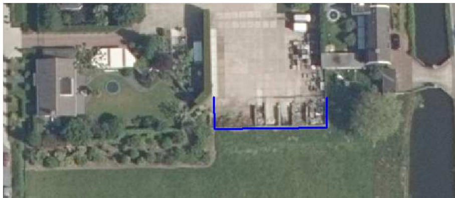
figuur 3 Situering benodigd geluidsscherm (in blauw aangegeven, met een hoogte van 6,5 m boven maaiveld hoveniersbedrijf)
