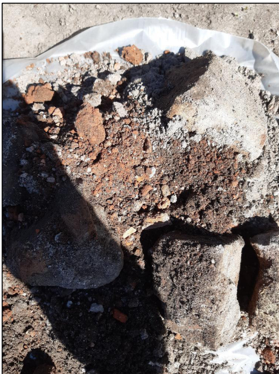
Foto 4: materiaal uiterst baksteenhoudende laag boring 07
