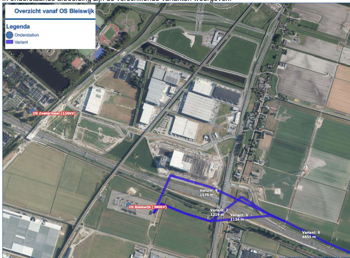
Afbeelding 3.13: Overzicht tracévarianten vanuit 380kV - station Bleiswijk.
