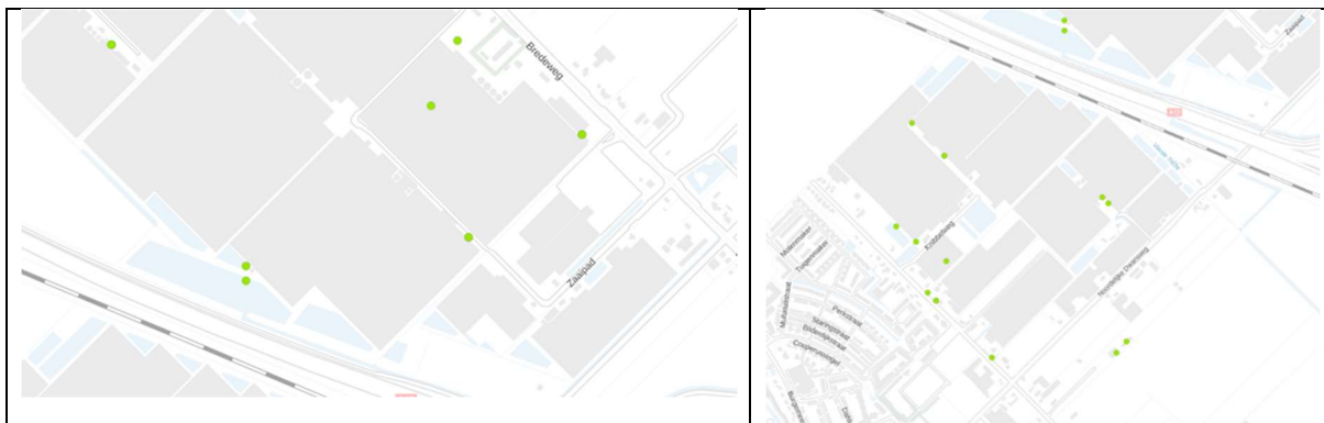
Afbeelding 3.3 Weergave onttrekking- en infiltratieputten ten noorden (links) en ten zuiden (rechts) van de A12.
