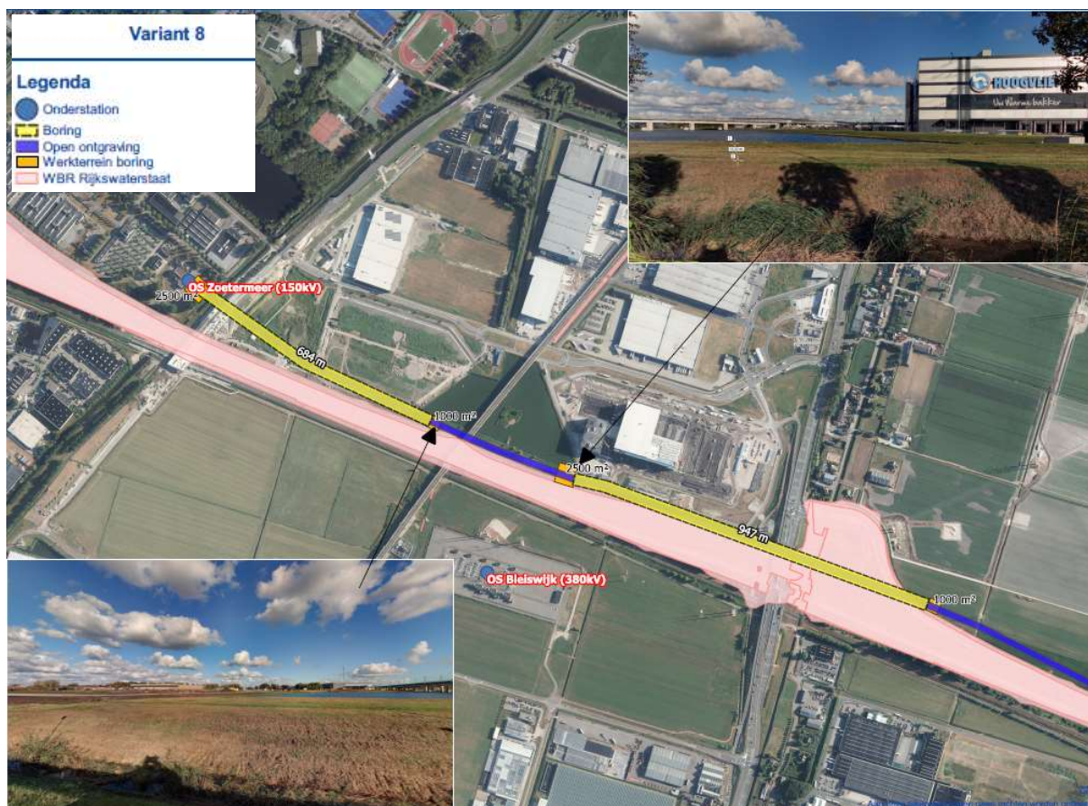
Afbeelding 3.12: Weergave tracé en belemmeringen variant 8.
