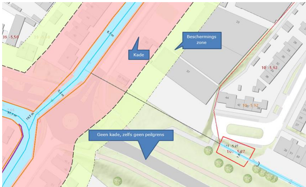
Figuur 3: Situatie duiker-watergang ter hoogte van N472 (Legger, Delfland)
