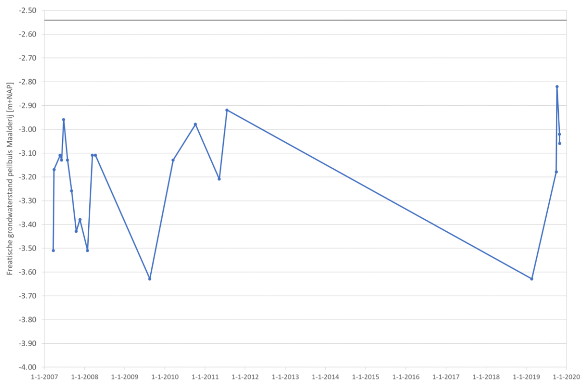
Figuur 5 Gemeten grondwaterstand in peilbuis Maalderij (op de projectlocatie)
