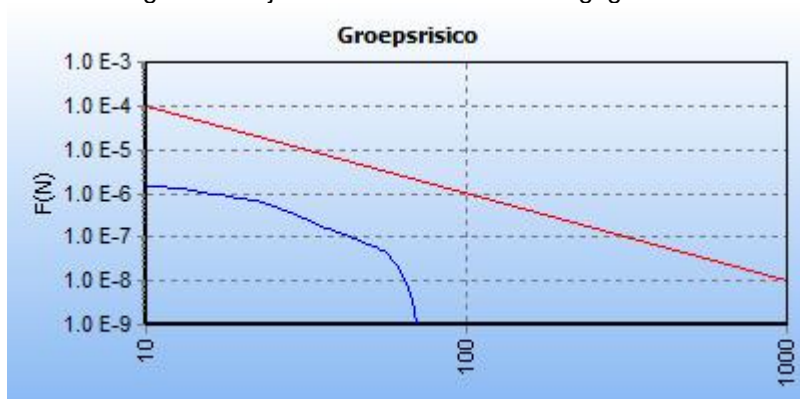
Afbeelding 9: FN-curve (blauwe lijn) van de maatgevende kilometer voor de huidige situatie afgezet tegen de oriëntatiewaarde (rode lijn).
