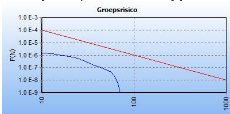
Afbeelding 11: FN-curve (blauwe lijn) van de maatgevende kilometer voor de plansituatie afgezet tegen de oriëntatiewaarde (rode lijn).
