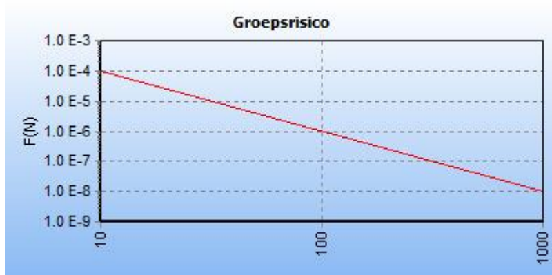
Afbeelding 13: FN-curve (blauwe lijn) van de maatgevende kilometer voor de huidige situatie afgezet tegen de oriëntatiewaarde (rode lijn).
