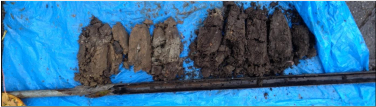
Boring 3: meermaals gestaakt in puin op 1,0 m -Mv.
