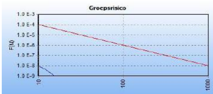
Figuur 2 fN-curve van het groepsrisico van de gasleiding
