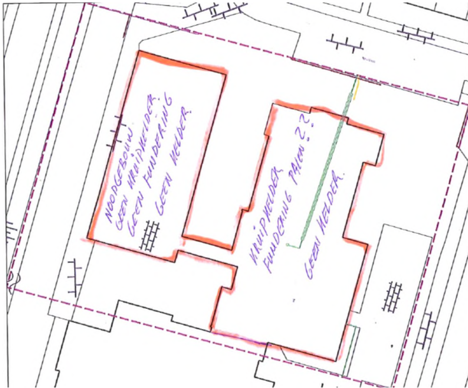
Afbeelding 2: Huidige bebouwing aan de Rembrandtlaan 44 te Bleiswijk, gemeente Lansingerland, met gegevens bouwarchief (Bron: bouwarchief, geraadpleegd door Antea Group).
