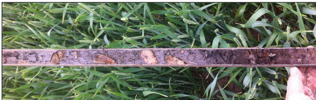
Figuur 3: Houtresten in de top van de oudere getijdenafzettingen in boring 24.
