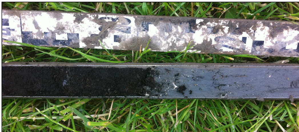
Figuur 4: Erosieve overgang tussen de dekafzettingen en het veen (boring 9, 230 cm -Mv)
