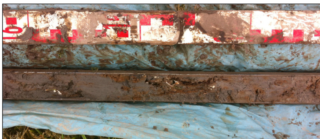
Figuur 6: zandlenzen tussen 135 en 145 cm -Mv (boring 15)
