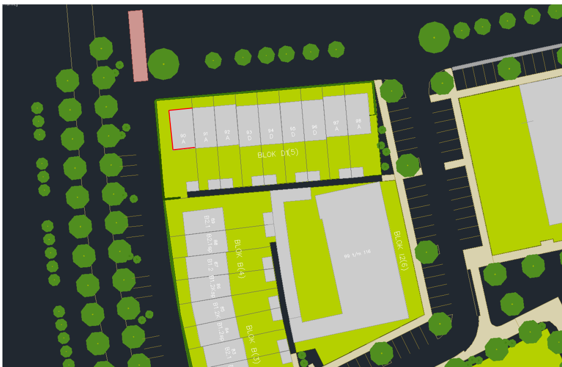
Afbeelding 1 : Woning Bouwnummer 90; rood aangeduide buitengevels zijn niet geluidsluw)
