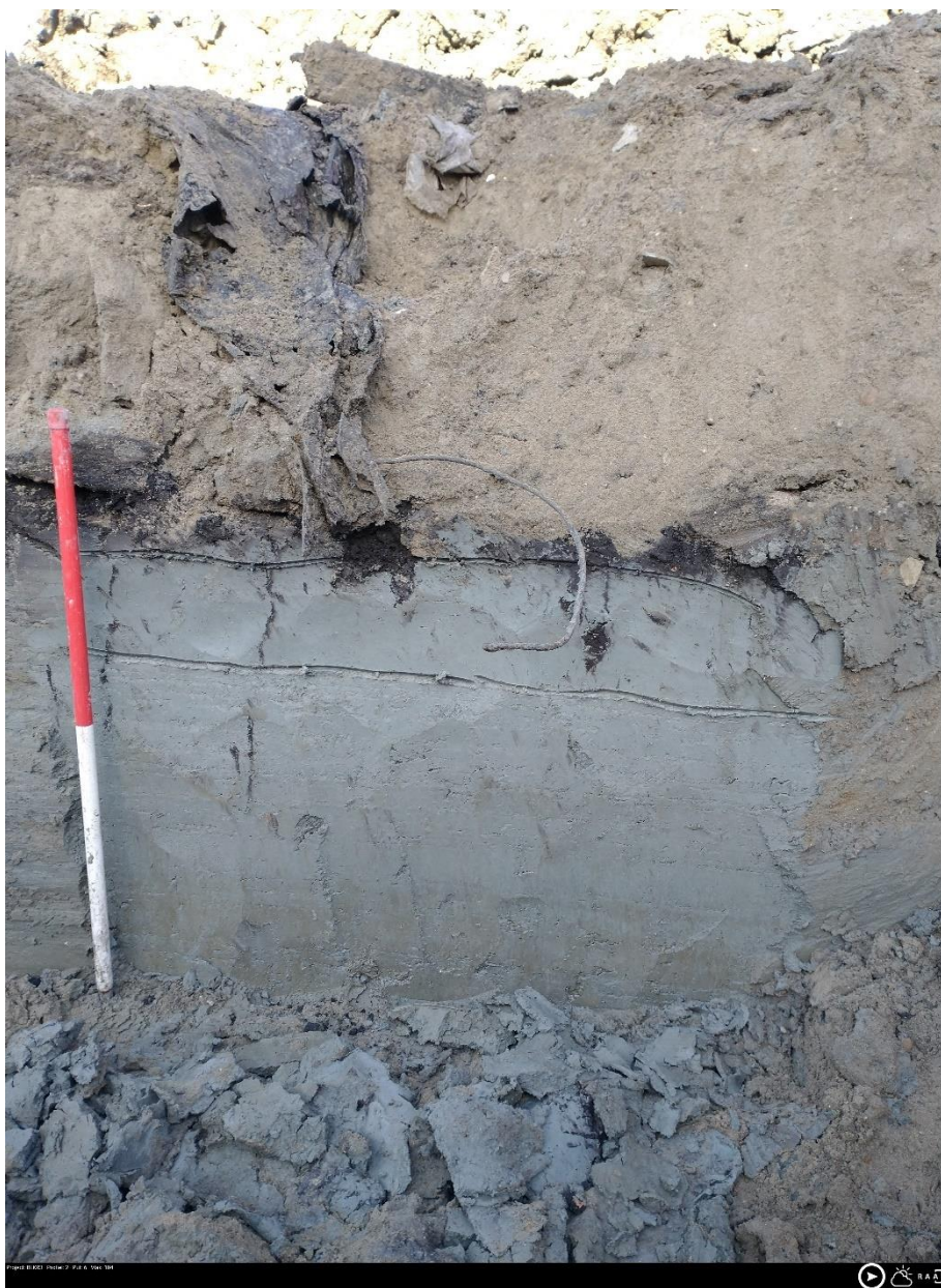
Figuur 5. Een representatieve profielkolom voor het noordelijk deel van het plangebied (Kruisweg 44; werkput 6, profiel 2).
