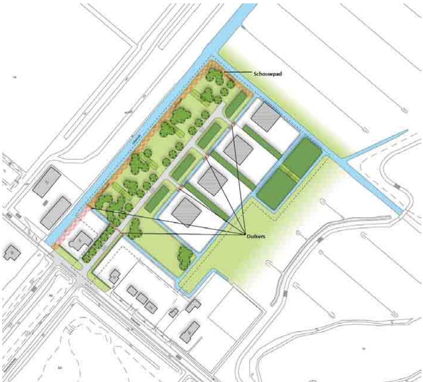
Afbeelding 1.2 Schouwpad, watergangen en duikers
