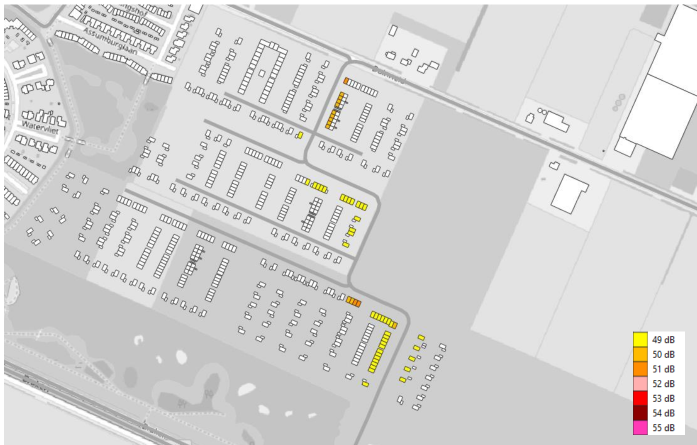
Figuur 3.6: Geluidsbelasting t.g.v. nieuwe weg – maximumsnelheid 30 km/h (inclusief correctie art. 110g Wgh.)
