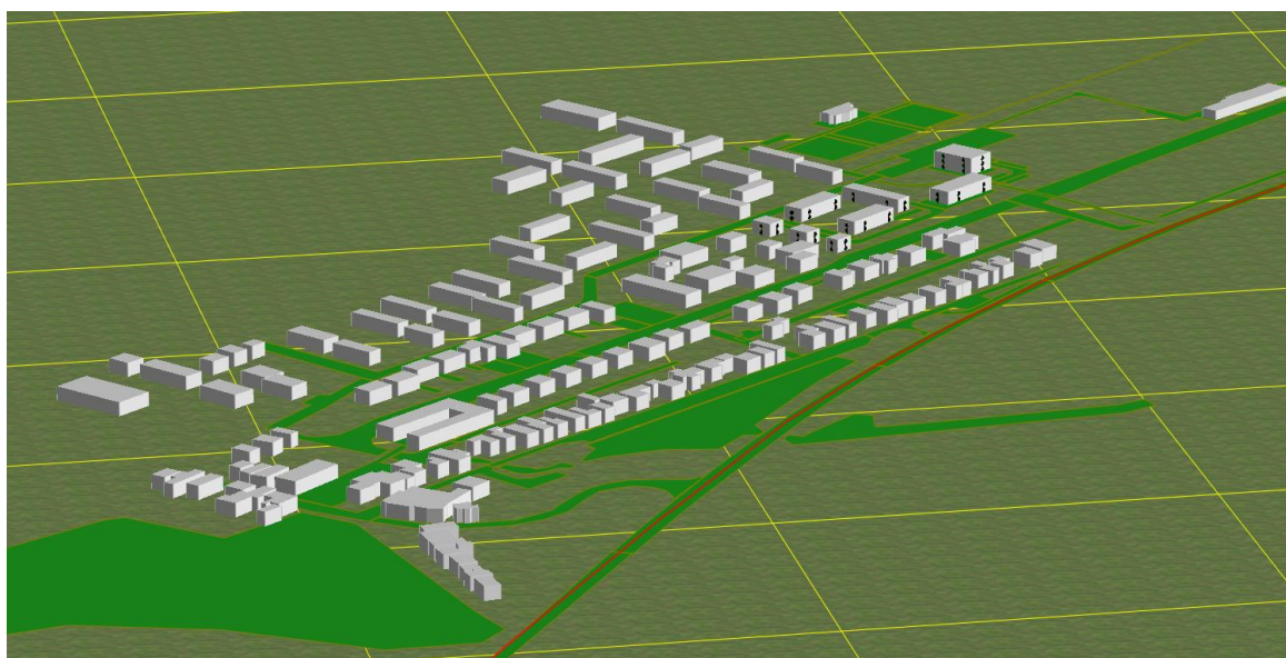
Afbeelding 4: overzicht 3D rekenmodel en ligging appartementengebouw
