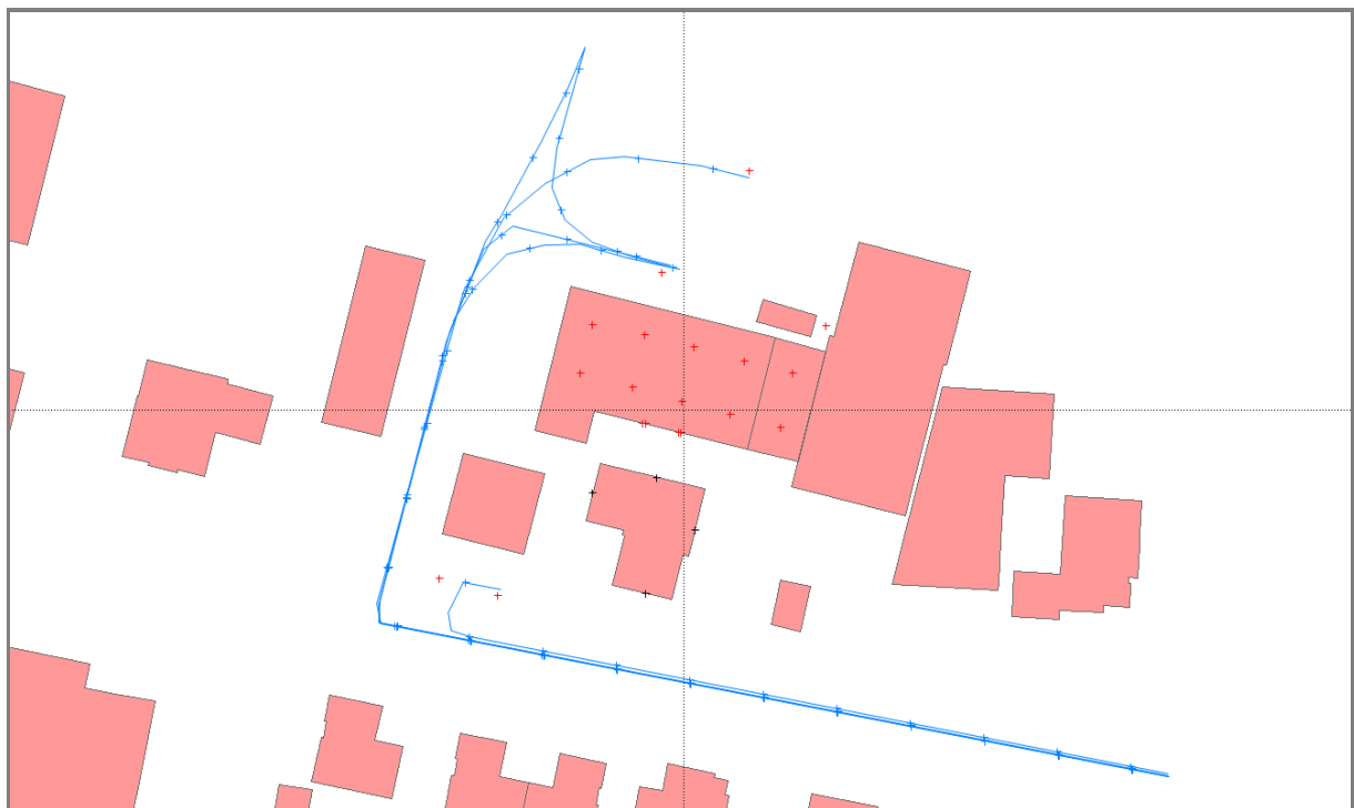
Figuur 3. Overzicht rekenmodel met de verschillende geluidsbronnen en waarneempunten op de woning
