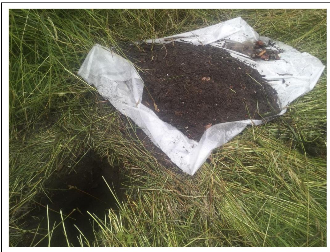
Foto 4. Asbestgat en opgegraven materiaal ASB-02
