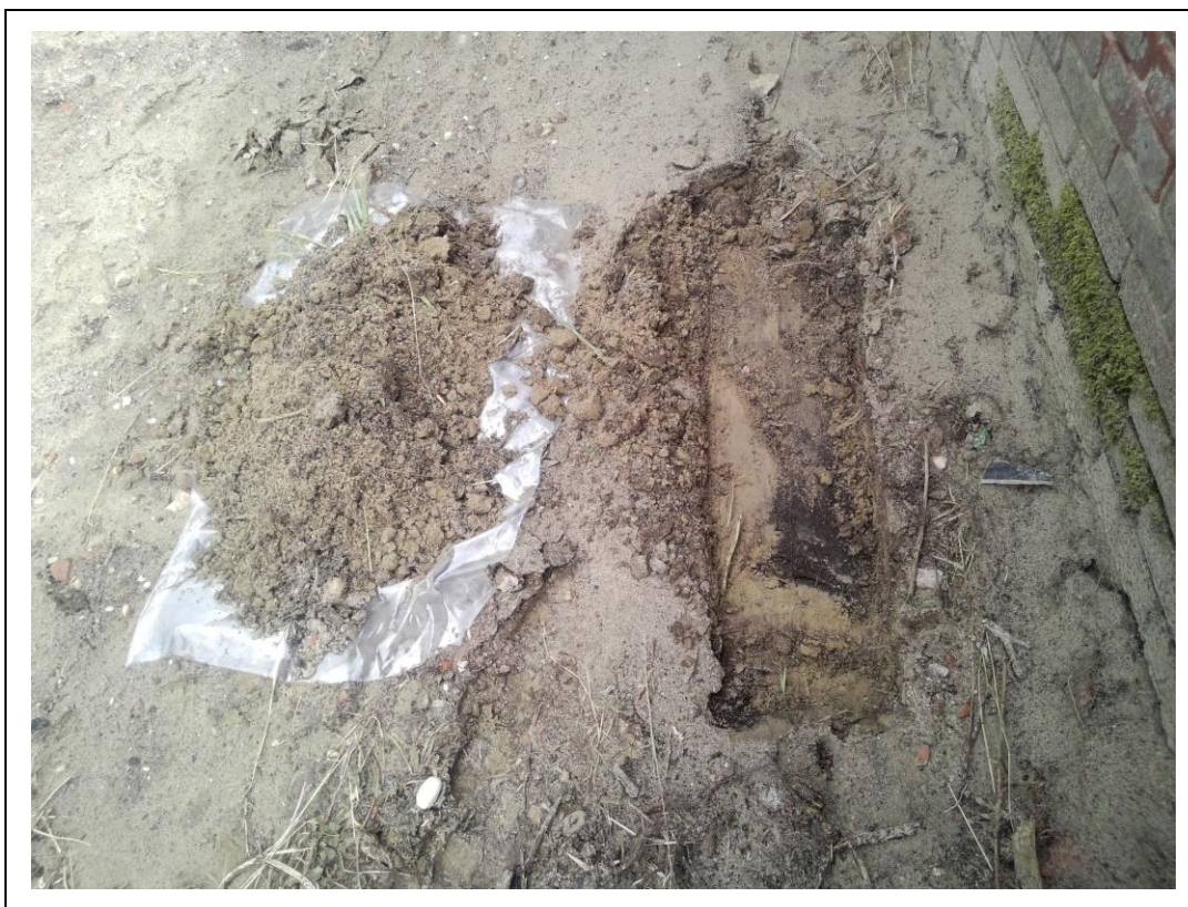
Foto 2. Asbestsleuf en opgegraven materiaal B02 (druppelzone)
