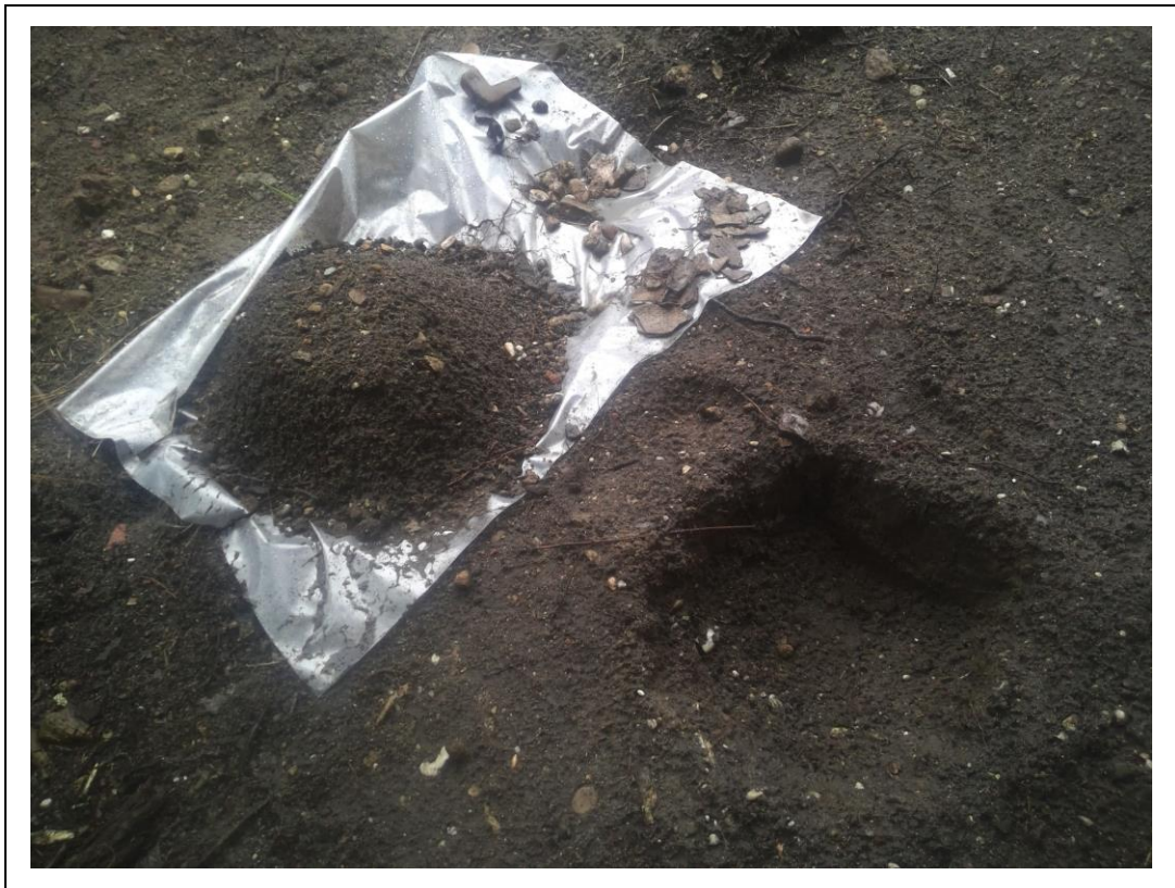
Foto 14. Asbestgat en opgegraven materiaal ASB-12
