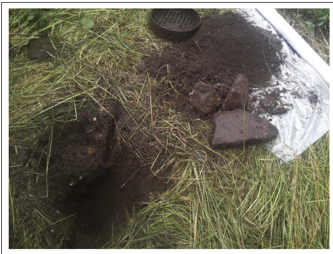
Foto 5. Asbestgat en opgegraven materiaal ASB-03
