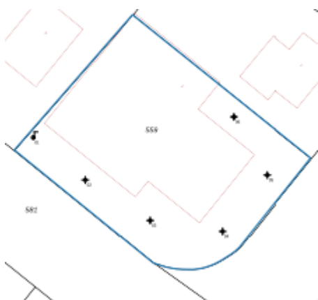
Onderzoekslocatie met boorpunten
