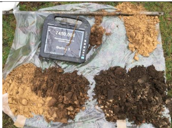
Boring 3, uitgelegd in trajecten van 50 cm (en laatste traject van 20 cm), van rechtsonder naar linksboven. Een 45 cm dik recent dek op een vlekkerige, geroerde laag (vermoedelijk niet recente geroerd).
