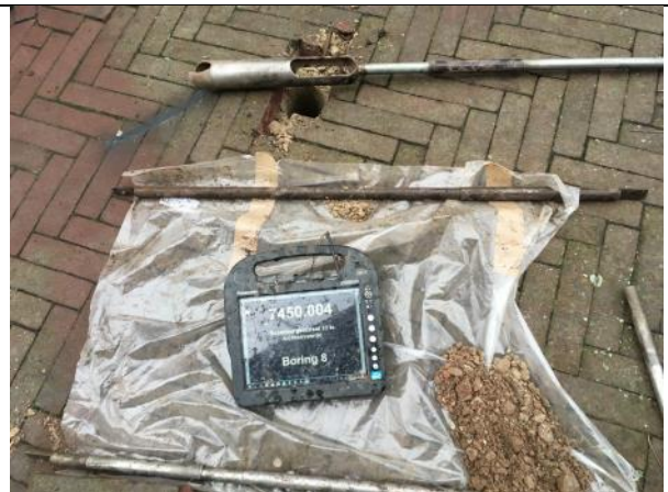
Boring 8, uitgelegd van rechts naar links. Massieve puinverharding onder de straatklinkers. Boring gestaakt op 35 cm -mv.
