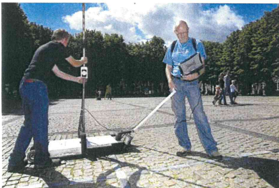
Voorbeeld van Groundtracer metingen in dit geval op de Parade in combinatie met landmeters (foto Marc Bolsius, Bron: Brabants dagblad)
