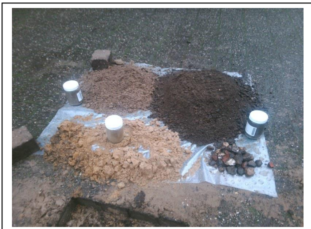
Foto 3. Opgegraven en gezeefd materiaal inspectiegat A03
