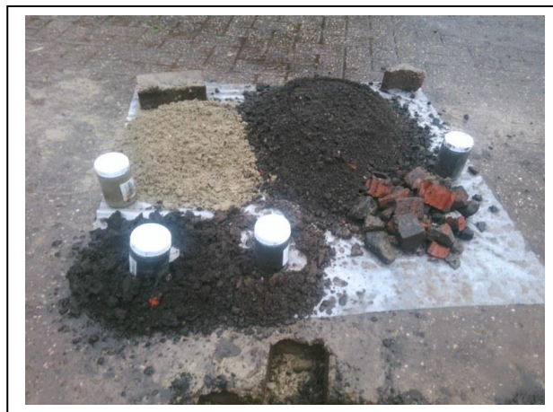
Foto 2. Opgegraven en gezeefd materiaal inspectiegat A02
