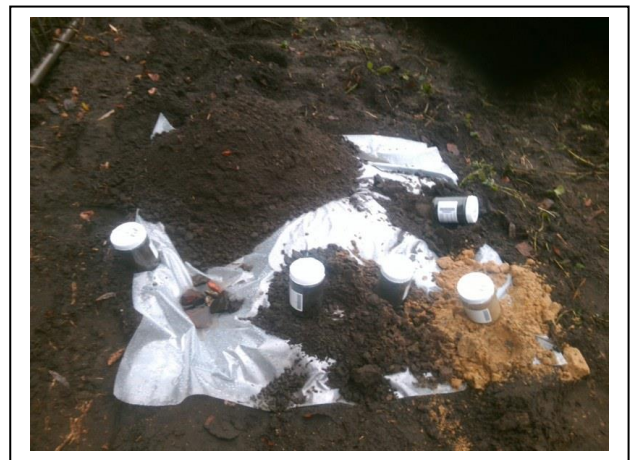
Foto 10. Opgegraven en gezeefd materiaal inspectiegat A10
