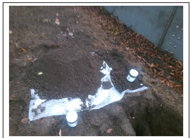
Foto 12 Opgegraven en gezeefd materiaal inspectiegat A12
