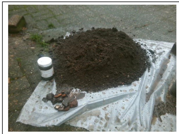
Foto 4. Opgegraven en gezeefd materiaal inspectiegat A04
