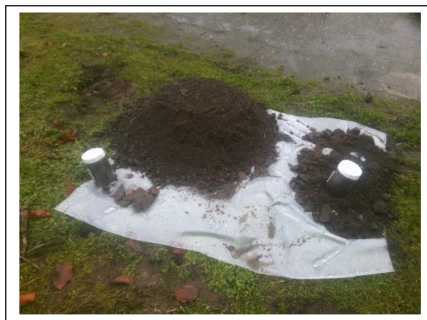
Foto 6. Opgegraven en gezeefd materiaal inspectiegat A06
