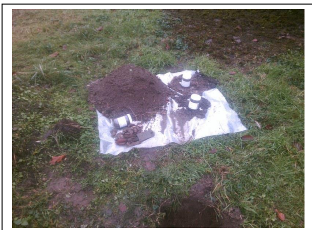
Foto 5. Opgegraven en gezeefd materiaal inspectiegat A05
