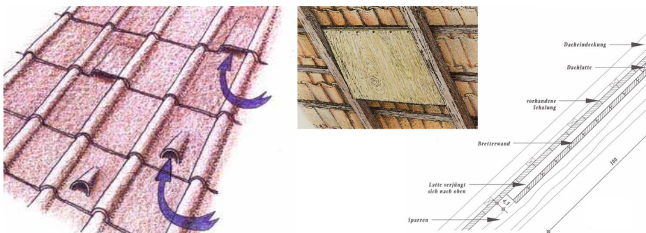
Afbeelding B2: Vleermuiskasten voor verwerking in de dakconstructie. (bron: http://niedersachsen.nabu.de )
