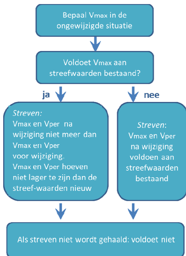
Figuur 13: Schematisatie toetsing trillingen conform SBR-richtlijn Trillingen deel B
