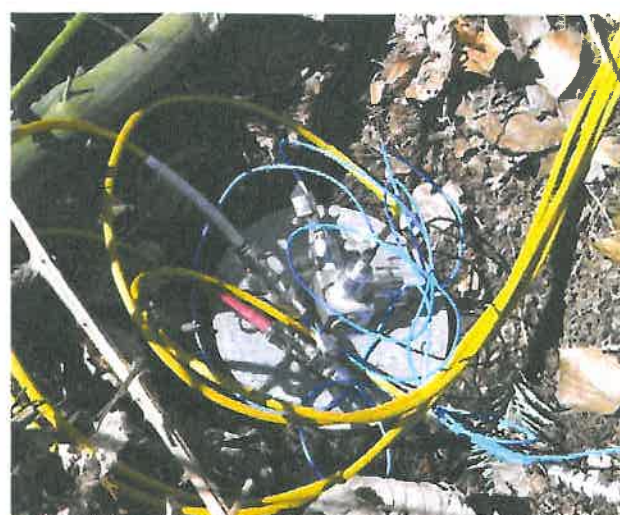
Figuur 2.3: Meetraai B, Opnemer piëzo versnellingsstelsel
