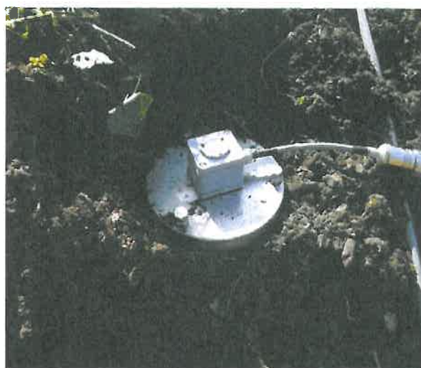
Figuur 2.2: Meetraai A, Opnemer rek versnellingsstelsel
