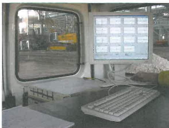
Figuur 2.4: Meetraai B, Opstelling piëzo versnellingen meetsysteem (foto elders genomen)
