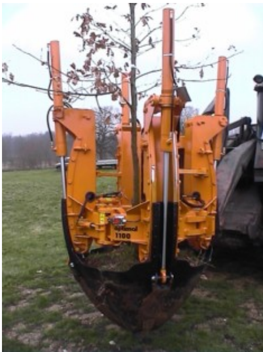
Inzet van verplantmachines met het Optimal-systeem.
