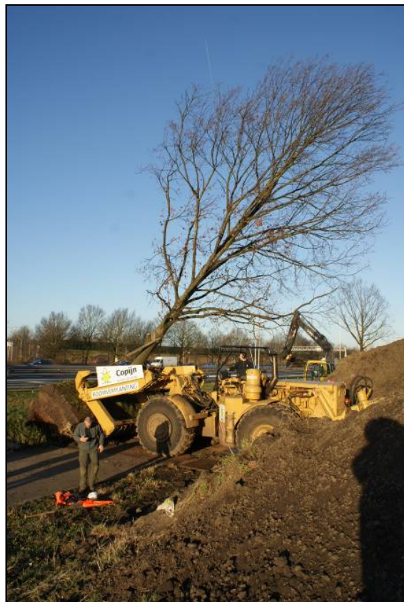
Boven: de boom wordt getuid en aan de verplantmachine verankerd. Onder: met de grote verplantschep worden bomen tot 24 ton gewicht en met een stamdiameter tot ruim 70 cm verplant.
