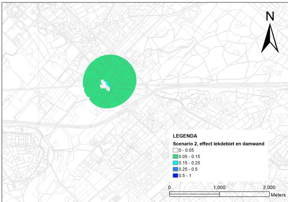
Figuur 3: Effect lekdebiets damwanden en onderwaterbeton, verlaging op de grondwaterstand in meters (gemiddelde situatie)
