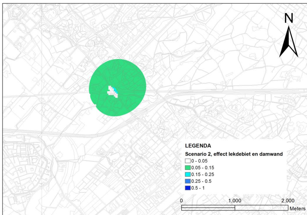
Afbeelding 10: Verlaging grondwaterstanden in meters bij onderwaterbeton
