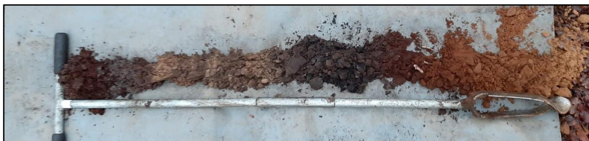
Figuur 8. Boorprofiel PB2. Een typische podzolgrond, met een duidelijke uit- en inspoelingslaag
