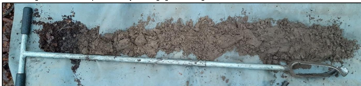
Figuur 7. Boorprofiel PB1. De bodem is vermoedeling geroerd, omdat er geen bodemvormende processen waargenomen zijn.
