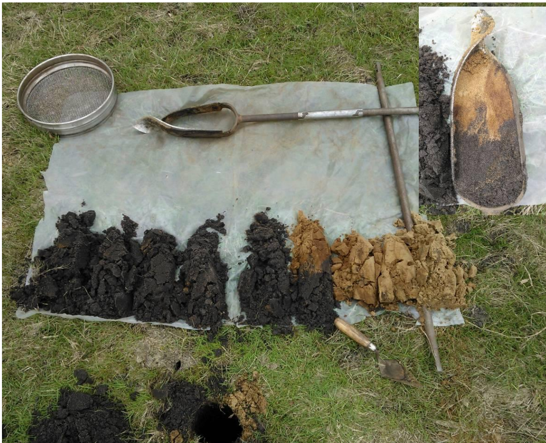
Afb. 3.3 Profiel met de akkerlaag op de C-horizont (boring 53). Inzet boorkop toont de scherpe laaggrens.
