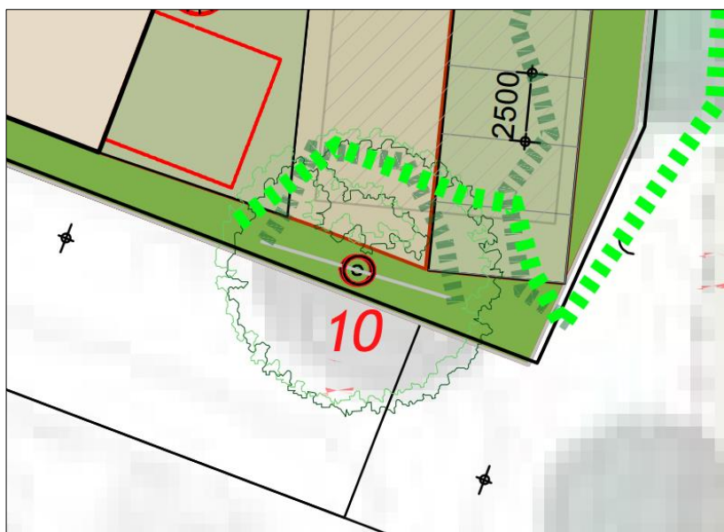
Afbeelding 31: Aanleg weg en parkeerplaatsen (met waterberging) nabij boom 10;
