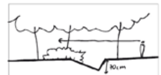
greppel met dichte gebiedseigen beplanting als grensafscheiding
